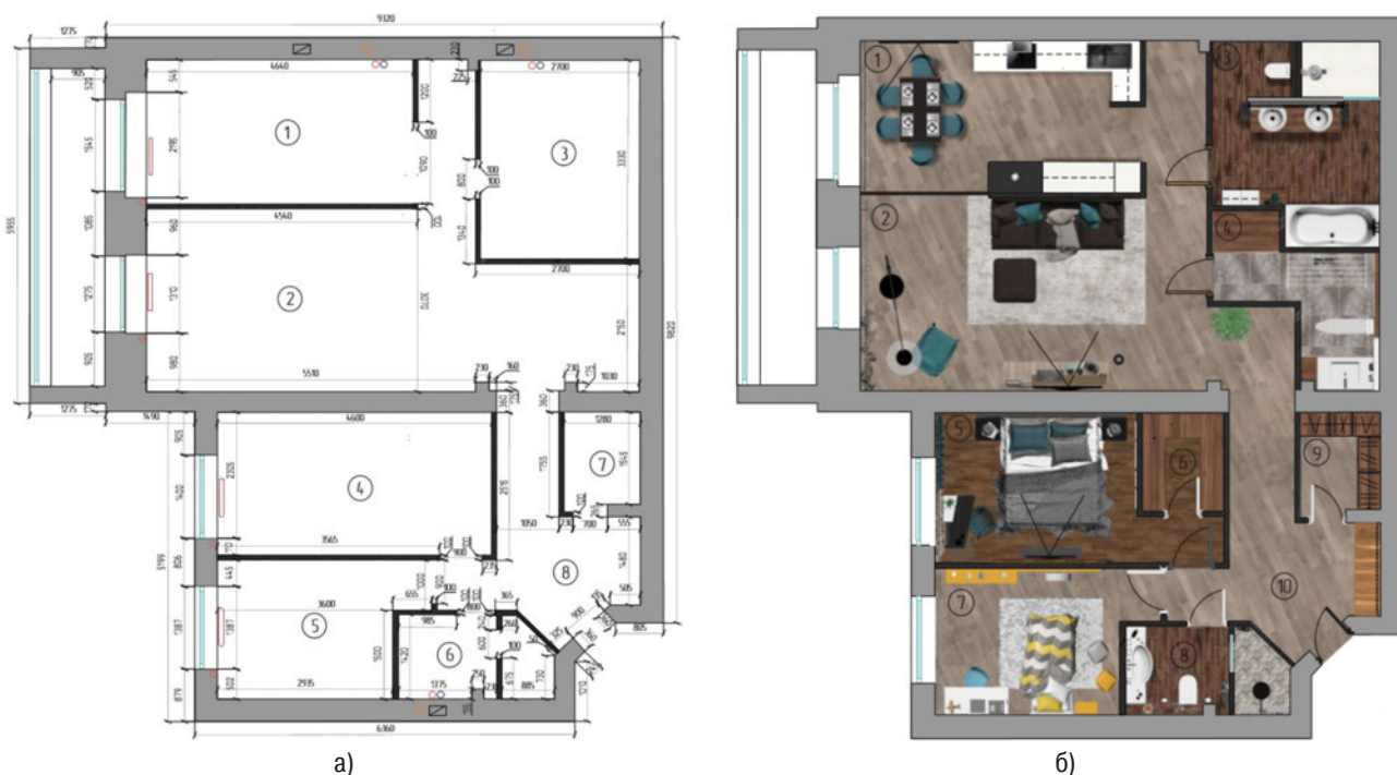
Рис. 3. Проектирование обмерного плана: а) обмерный план в масштабе 1:1; б) план расстановки мебели и напольных покрытий
